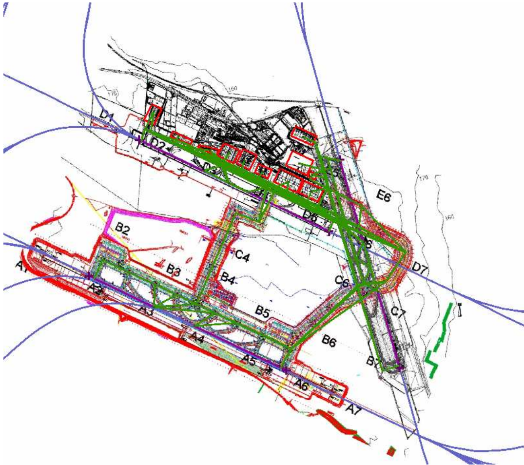
Abbildung 4.19-8: Planszenario Linienquellen-Bündel mit den Rollwegen (grün) und den Abflugrouten (blau)
